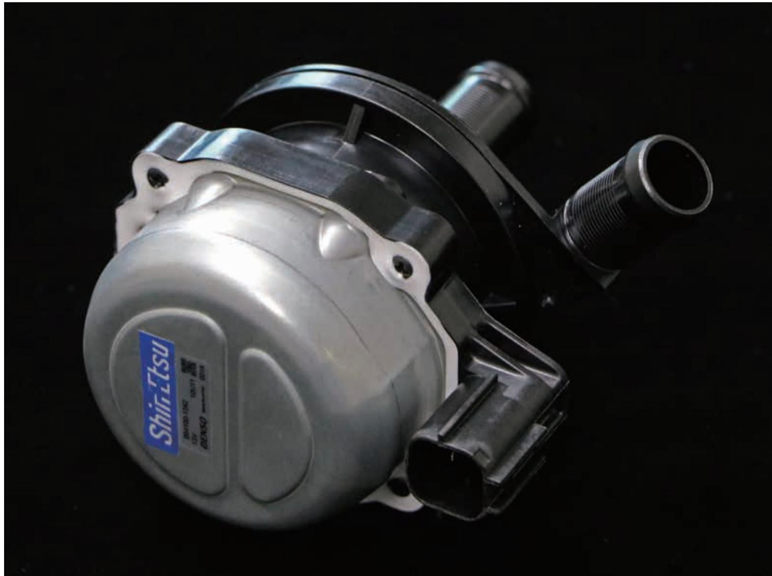
発熱するエンジンを冷やすため、ウォーターポンプでクーラントを循環させラジエータで熱交換し放熱させています。従来の自動車では、ウォーターポンプの駆動力はエンジンから得ているため、吐出されるクーラントの量はエンジン回転数に比例し、任意にコントロールすることが難しく非効率でした。ハイブリッド自動車、電気自動車および燃料電池自動車に採用されている電動ウォーターポンプは、回転数を任意にコントロールできるため、クーラントの循環量を高効率に制御することが可能となりました。[信越レア・アースマグネット](#)は、電動ウォーターポンプ用モータに採用され、効率的な冷却性能の実現に貢献しています。
