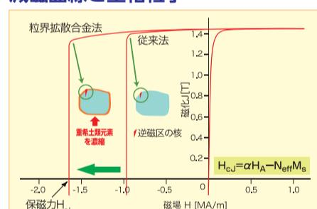
最大エネルギー積  $414\text{kJ/m}^3$  ( $52\text{MGOe}$ ) で保磁力  $1.55\text{MA/m}$  ( $=19.5\text{kOe}$ ) を達成。
