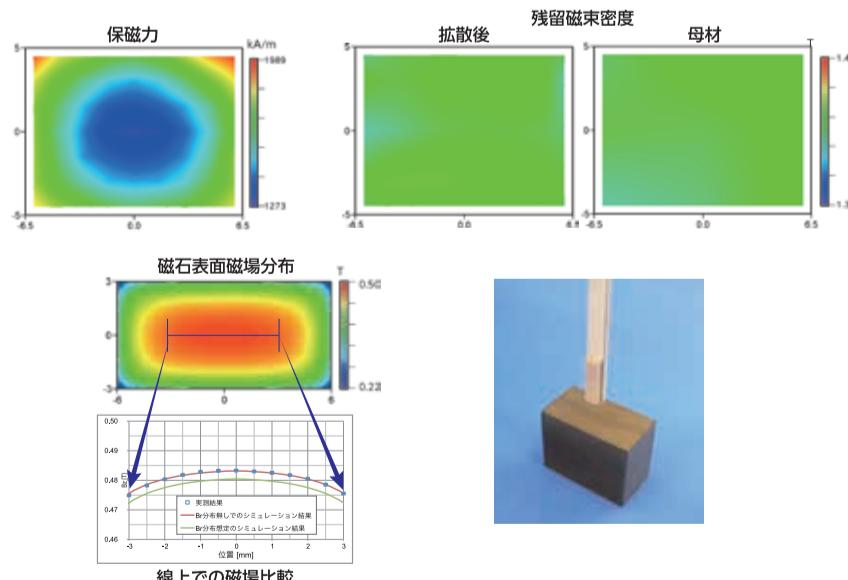
粒界拡散により、磁石保磁力  $H_{cJ}$  が表面で高く内部にいくに従い低くなる保磁力分布磁石を作製することができます。
