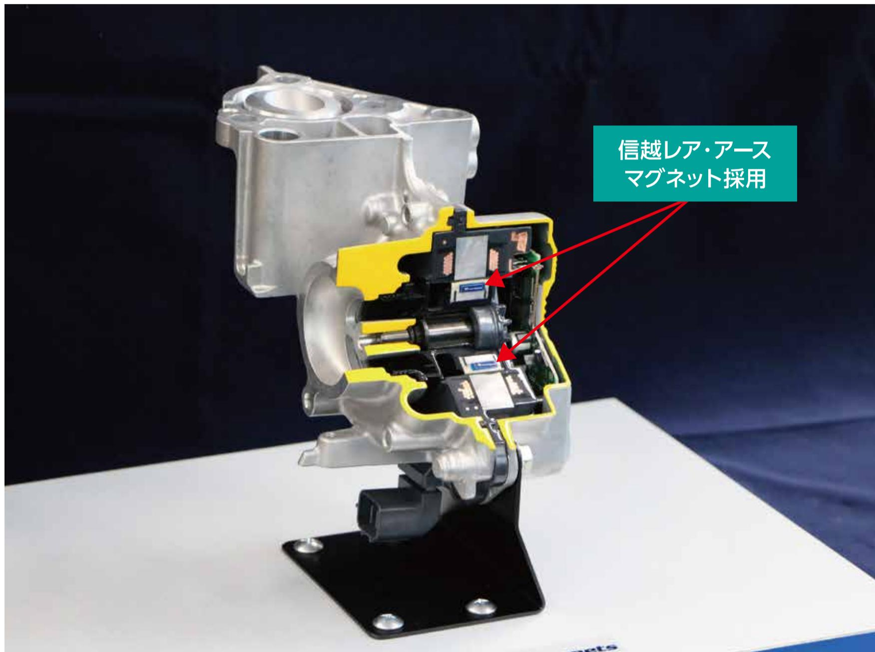
発熱するエンジンを冷やすため、ウォーターポンプでクーラントを循環させラジエータで熱交換し放熱させています。従来の自動車では、ウォーターポンプの駆動力はエンジンから得ているため、吐出されるクーラントの量はエンジン回転数に比例し、任意にコントロールすることが難しく非効率でした。ハイブリッド自動車、電気自動車に採用されている電動ウォーターポンプは、回転数を任意にコントロールできるため、クーラントの循環量を高効率に制御することが可能となりました。信越レア・アースマグネットは、電動ウォーターポンプ用モータに採用され、効率的な冷却性能の実現に貢献しています。
