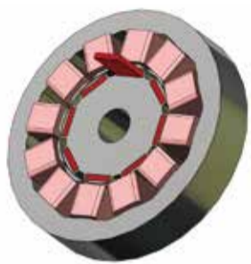
IPMモータ用磁石のパーミアンス分布例
